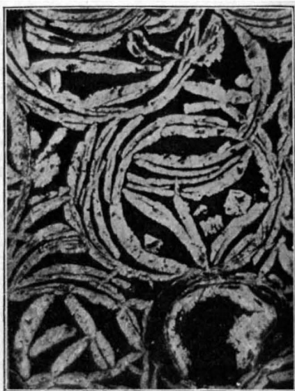
FIG. 1.— \times 30 . Sn, 75 per cent.; Sb, 20 per cent.; As, 5 per cent.
